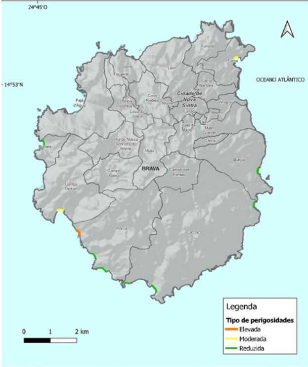
Figura 22: Suscetibilidade à erosão das praias, devido à subida do nível do mar (ilha de Brava). Elaboração própria baseada no mapeamento UNDP, 2014 .
