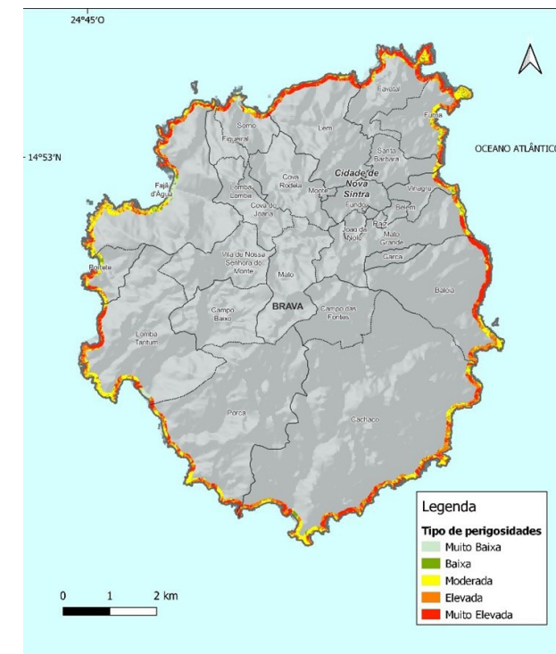
Figura 24. Suscetibilidade a movimentos de vertente na faixa costeira, devido a períodos de chuva intensa (ilha de Brava). Elaboração própria baseada no mapeamento UNDP, 2014
